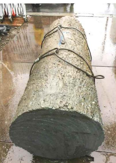
引き抜き、切断した「場所打ち杭」。
